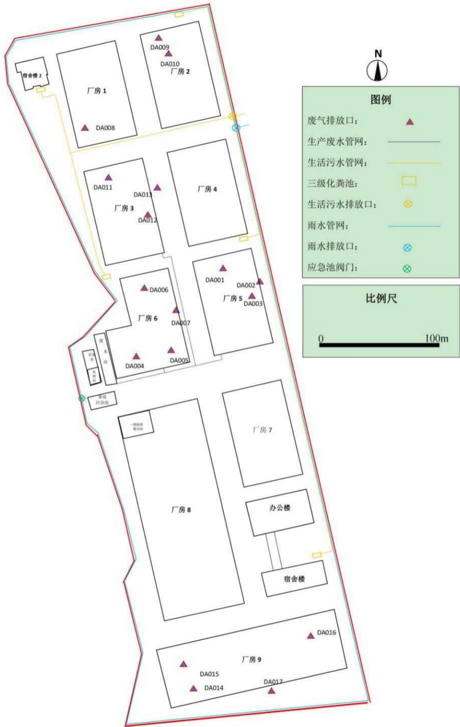
附图 3 废水收集管网图
